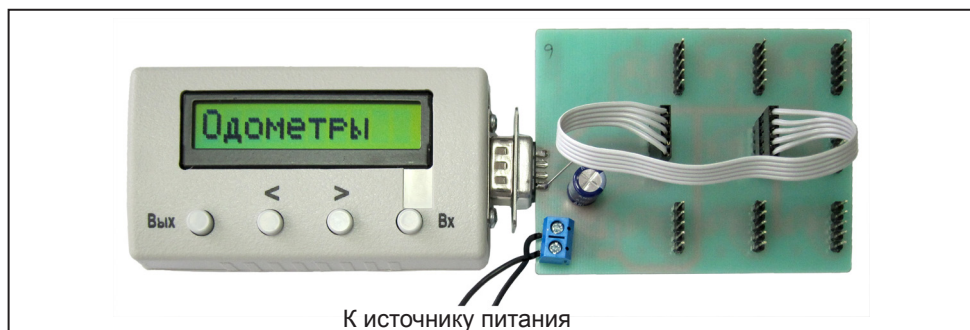
Рисунок 2. Подключение адаптера ПО5-EEPROM к программатору
