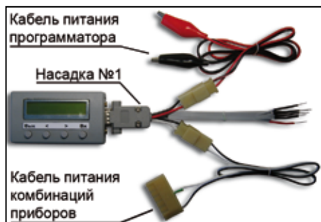
Рисунок 4. Подключение насадок и кабелей питания для программирования одометров
